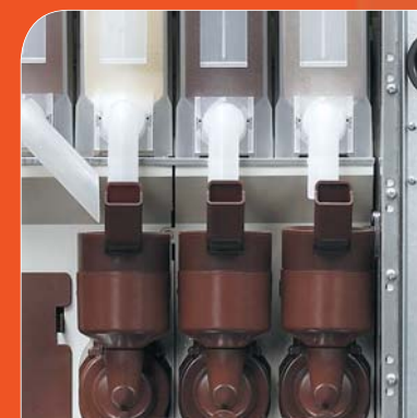
Mezclador FAS con sistema de autoaspiración.
